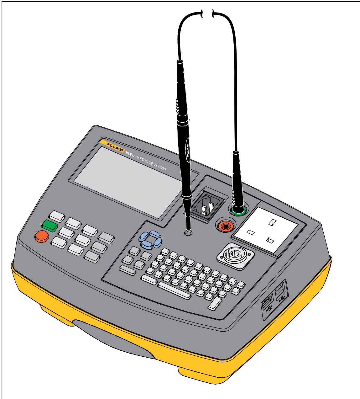
Afbeelding 1. Aansluitingen voor compensatie van de meetsnoerweerstand
